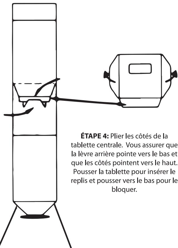
**ÉTAPE 4:** Plier les côtés de la tablette centrale. Vous assurer que la lèvre arrière pointe vers le bas et que les côtés pointent vers le haut. Pousser la tablette pour insérer le replis et pousser vers le bas pour le bloquer.
