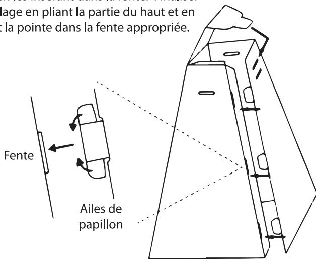
**ÉTAPE 2:** Plier tous les angles de l'unité du haut. Assembler le haut en pliant les ailes du papillon en les insérant dans la fente. Finaliser l'assemblage en pliant la partie du haut et en insérant la pointe dans la fente appropriée.
