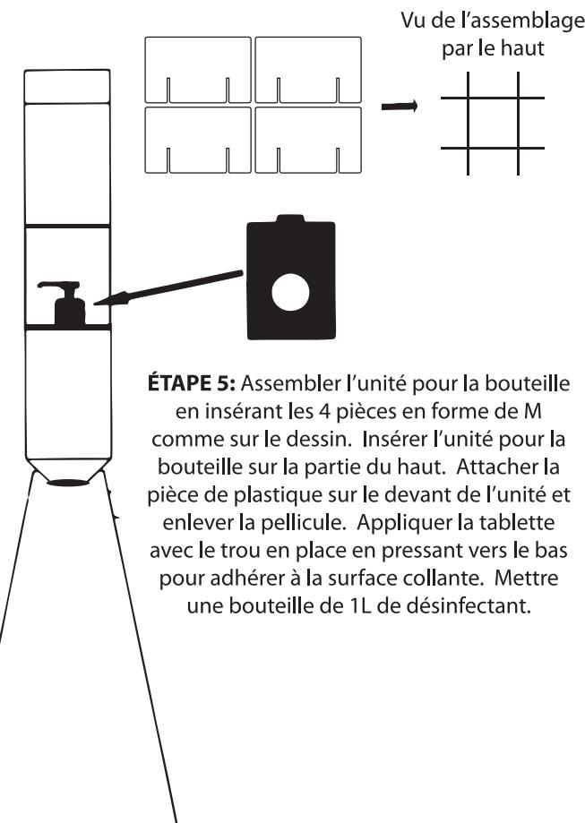
**ÉTAPE 5:** Assembler l'unité pour la bouteille en insérant les 4 pièces en forme de M comme sur le dessin. Insérer l'unité pour la bouteille sur la partie du haut. Attacher la pièce de plastique sur le devant de l'unité et enlever la pellicule. Appliquer la tablette avec le trou en place en pressant vers le bas pour adhérer à la surface collante. Mettre une bouteille de 1L de désinfectant.
